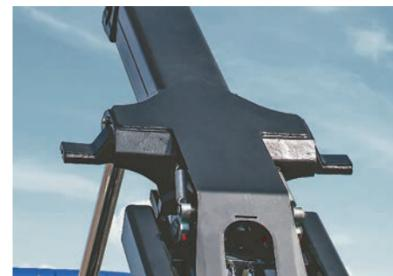
**Дополнительные опоры** на средней раме. Конструкция позволяет увеличить надежность фиксации бункера при работе в самосвальном режиме (особенно при разгрузке на неровных площадках).
