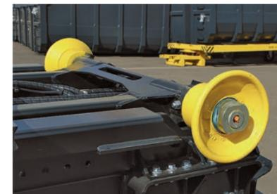
**Литые ролики** увеличивают ресурс работы крюкового погрузчика.
