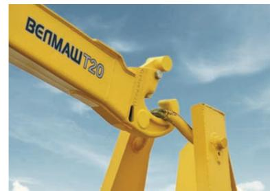
**Литой крюк.** Специальная конструкция крюка и замка обеспечивают надежный захват кузова.
