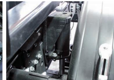
**Система стабилизации** уменьшает вероятность отрыва от земли передних колес шасси автомобиля при работе с бункером или платформой.
