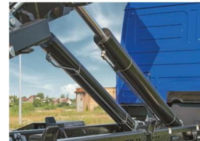
**Гидроцилиндры подъема средней рамы** производства концерна ПАЛФИНГЕР.
