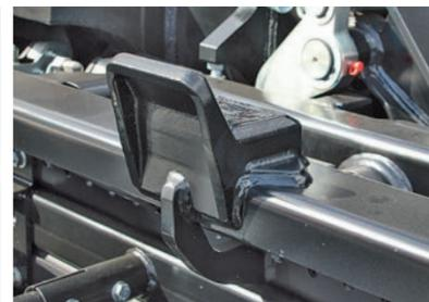
**Литые износостойкие опоры** предотвращают боковое смещение бункера при транспортировке.
