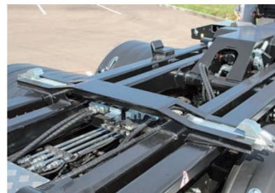
**Гидравлические замки кузова** обеспечивают удержание бункера или платформы на крюковом погрузчике.
