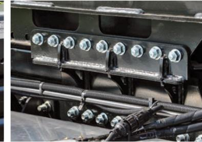
**Болтовой монтаж.** Ряд отверстий по несущей раме оборудования облегчает монтаж и исключает сварочные работы.
