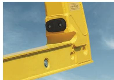
**Литая вставка и толкатель.** Литая вставка в углу крюковой стрелы убирает концентраторы напряжений. Толкатель демпфирует возможные удары.
