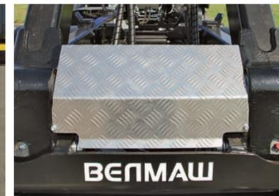
**Алюминиевая защита гидравлических узлов** предотвращает механическое повреждение элементов.
