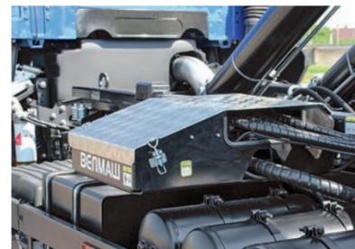
**Гидрораспределитель с пневматическим / электроуправлением.** Узел находится в специальном защитном ящике. Простая и надежная система обеспечивает полный контроль управления крюковым погрузчиком.
