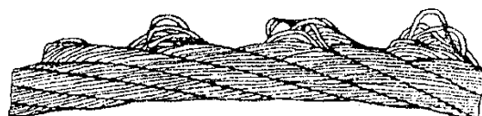
Рис.8: Выдавливание проволок прядей - в одной пряди; - в нескольких прядей
