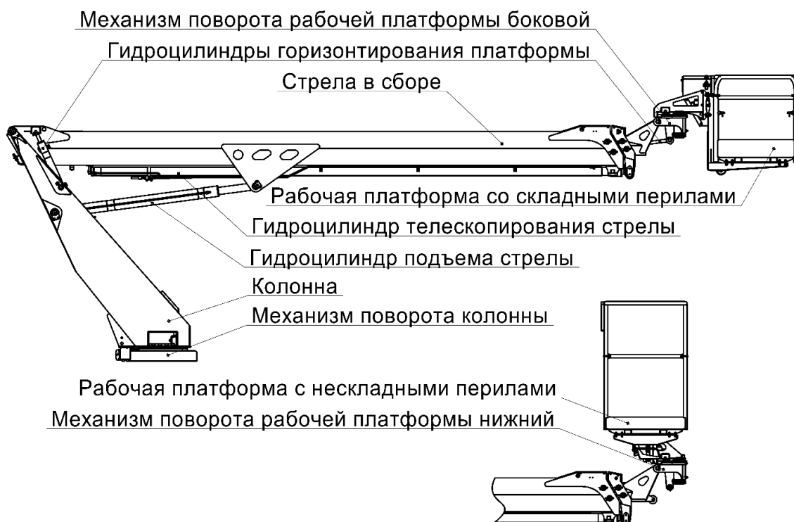
Рис. 2.2 – Состав подъемника
