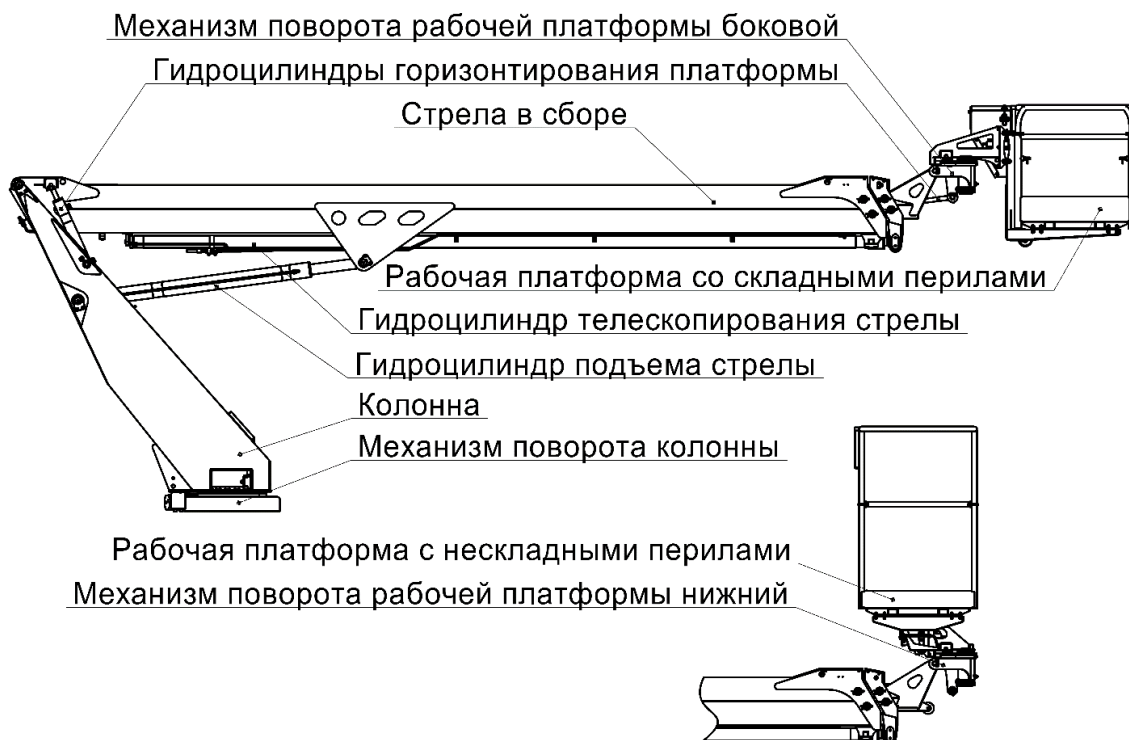
Рис. 2.2 – Состав подъемника
