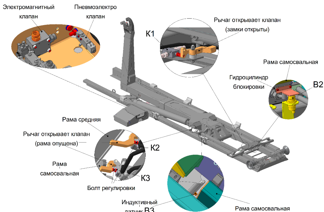
Рисунок 4.2 – Расположение клапанов ограничения перемещения и выключателя бесконтактного индуктивного
