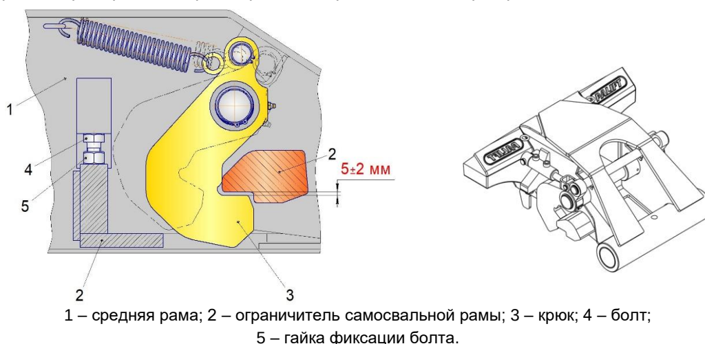
Рисунок 4.3 – Блокировка средней и самосвальной рам оборудования
